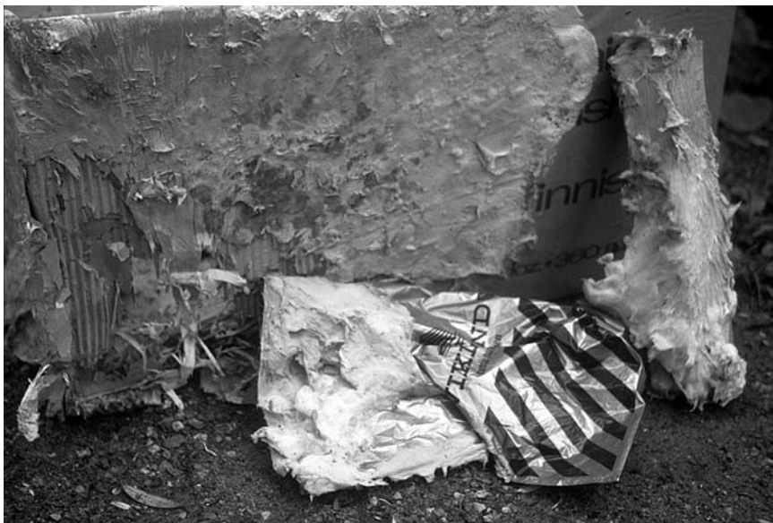
Pintarihmasto on tyypillisesti likaisen-harmaata. Tässä se on levittäytynyt kellarin seinän vieressä olleeseen pahvilaatikkoon ja muovipussiin
