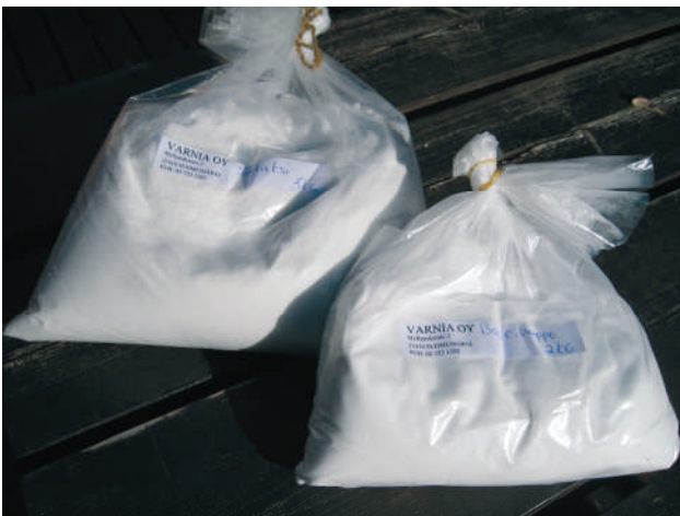
Booraksi ja boorihappo ovat valkoisia jauhemaisia aineita, jotka liukenevat parhaiten kuumaan veteen. Käyttämäni liuosvahuus oli 5 % booraksi ja 2 % boorihappoa.
