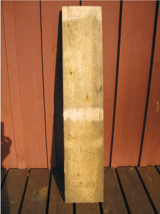
Kuusipuisen testilaudan alaosa on käsitelty booriliuoksella, jonka jälkeen koko lauta on vernissattu. Molemmat osat ovat voimakkaasti homehtuneet.
