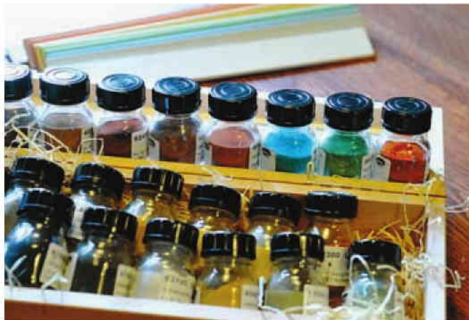
Maalari kuljettaa sävytyskokeiluihin tarvittavat pigmentit työmaalle pienissä lasipulloissa.
